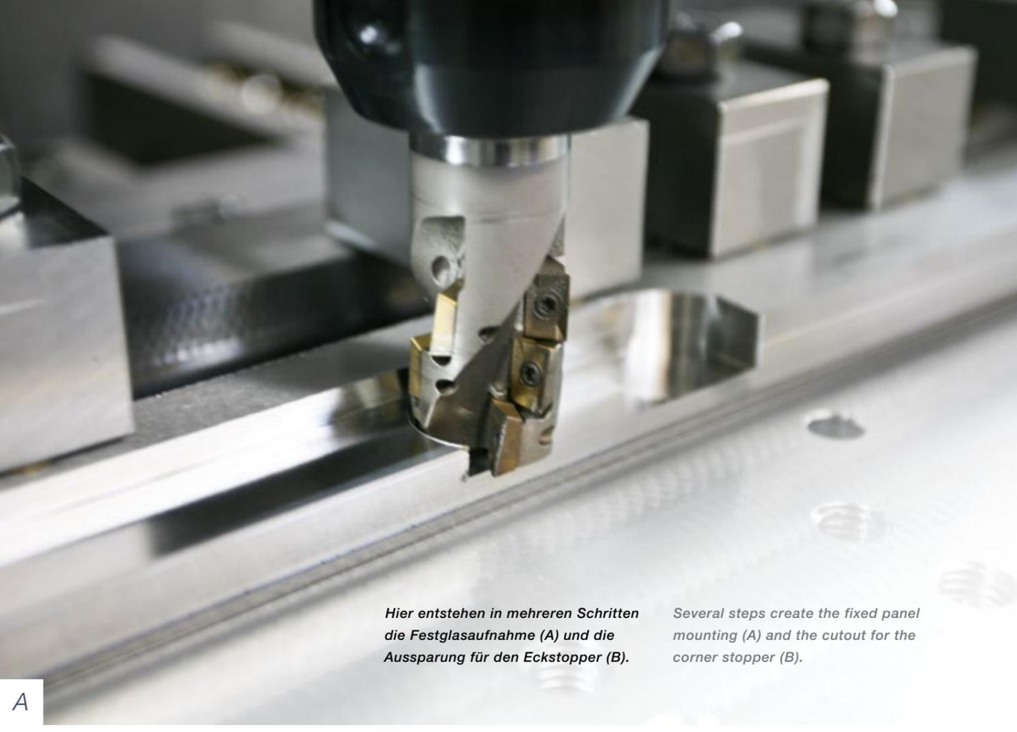
Hier entstehen in mehreren Schritten die Festglasaufnahme (A) und die Aussparung für den Eckstopper (B).
