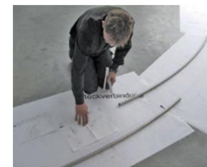
*Der gefertigte Laufschienebogen wird bei der Montage passgenau auf der Technikzeichnung ausgelegt und mit ihr abgeglichen.*
